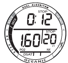
Fig. 41 - PO2 ALARM DECO
